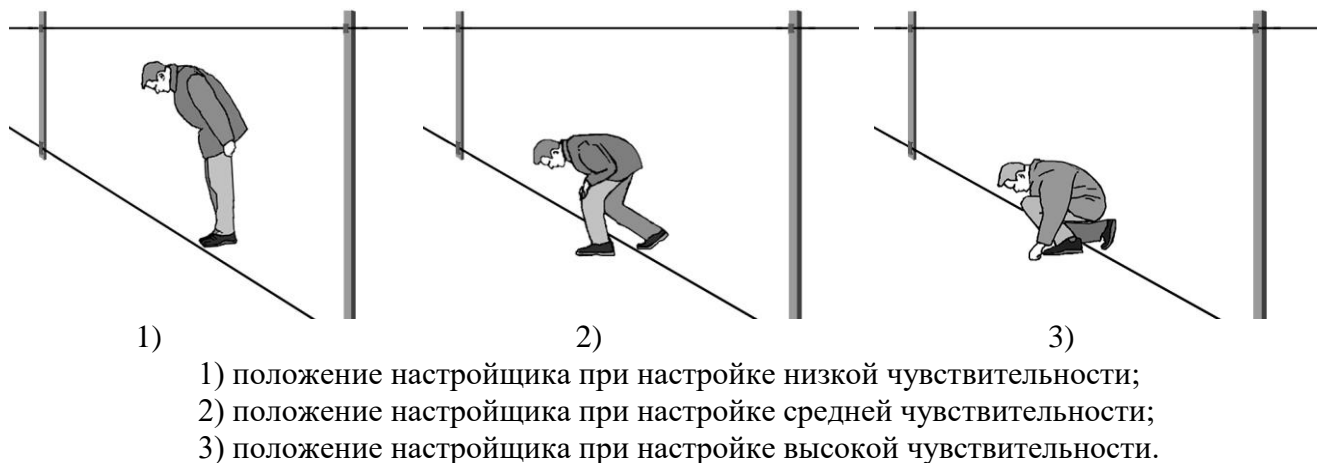
Рисунок 2.11 Способы имитаций преодоления 30 при приземном варианте установки.
